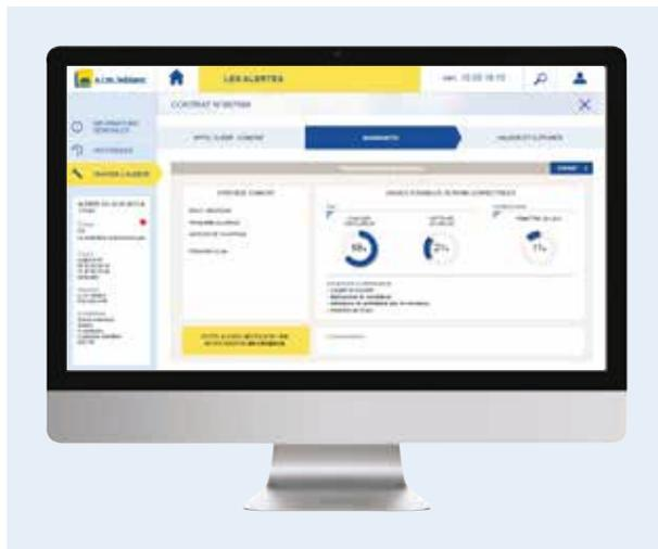
L'interface de la plateforme *Optibox* dédiée aux entreprises de maintenance, permet de visualiser toutes les chaudières connectées, leur état, les interventions prévues, les dysfonctionnements et les préconisations de remplacement suggérées par le système.
